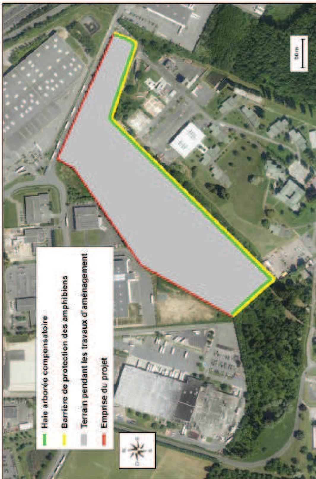
Figure 27 : Carte de localisation des mesures de réduction après les travaux d'aménagement
